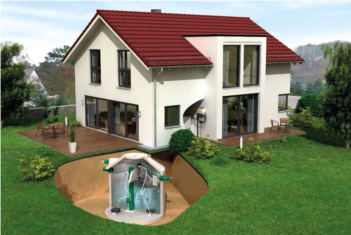
Abb. 2: SBR-Kleinkläranlage LKT-BIOlogo – mit digitaler WLAN-fähiger Steuereinheit.
