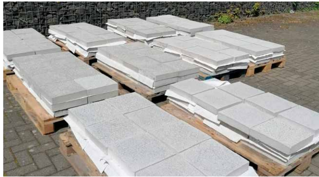
Abb. 6: (links) Bürogebäude mit wiederverwendeter betoShell®-FLEX30 Fassade, (oben rechts) RC-Gesteinskörnung aus betoShell® FLEX30, (unten rechts) Gehwegplatten mit 65 % RC-Material.
