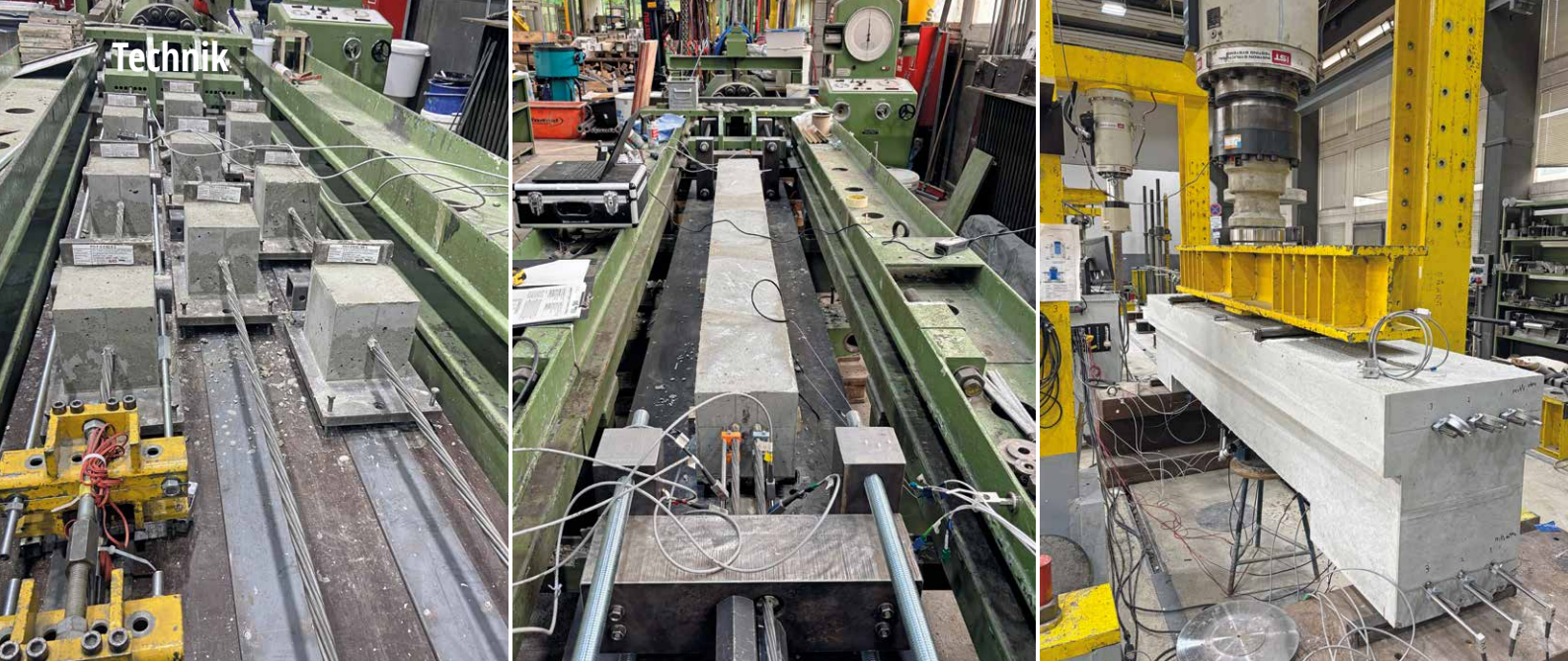
Versuchsstände der drei Versuchsreihen: Vorgespannte Pull-Out-Versuche (links), Spannkrafteinleitungsversuche (mitte), Balkenversuche unter zyklischer Beanspruchung (rechts).
