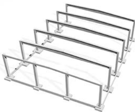
Typische Hallentragkonstruktionen: Binderkonstruktion (links), Pfetten-Binder-Konstruktion (rechts).
