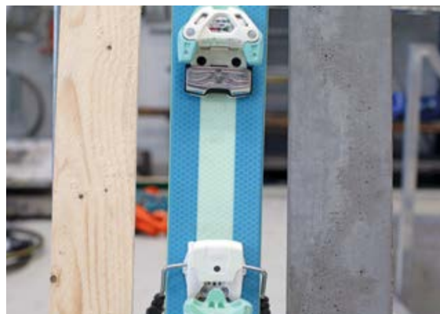
Im Labor der TU werden die Materialeigenschaften eines klassischen Skis mit Holzkern und eines Skis mit Textilbetonkern getestet.
