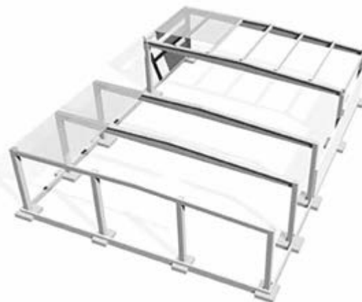
Typische Hallentragkonstruktionen: Binderkonstruktion (links), Pfetten-Binder-Konstruktion (rechts).
