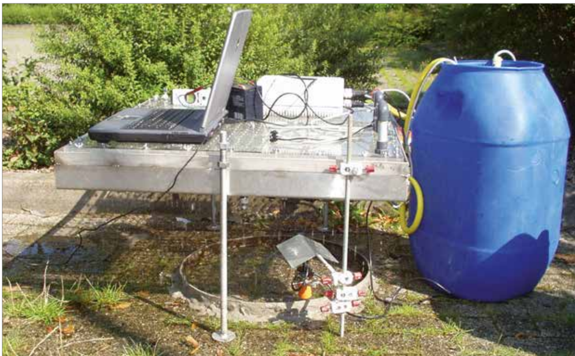
Versickerungsmessung an einer Bestandsfläche mittels Tropfinfiltrimeter.
