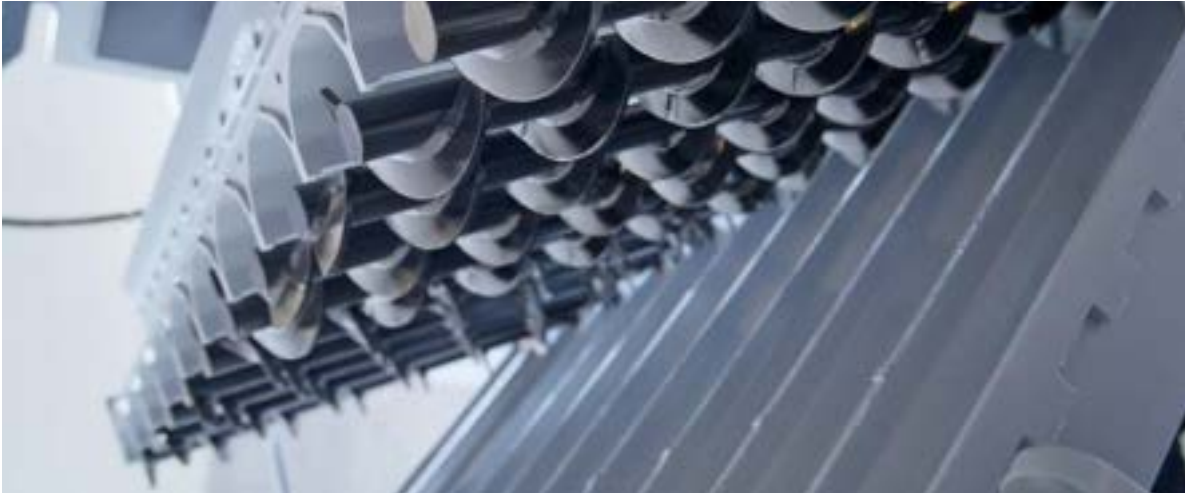
Betonverteiler mit Schneckenaustrag für die präzise Dosierung von Beton zur Herstellung von Decken- und Fassadenelementen.
