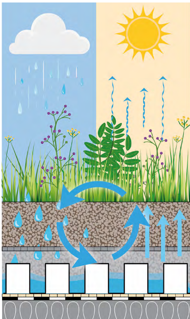
Schematische Darstellung des Wasserkreislaufs einer Dachbegrünung.
