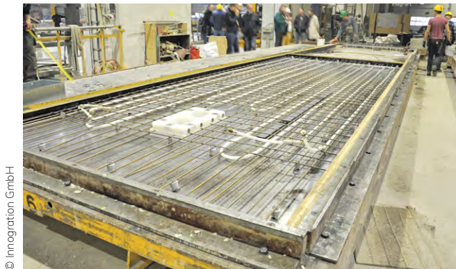
Abb. 6: Herstellung der Deckenelemente mit Rohrregister und Kasten für die Heizverteiler.
