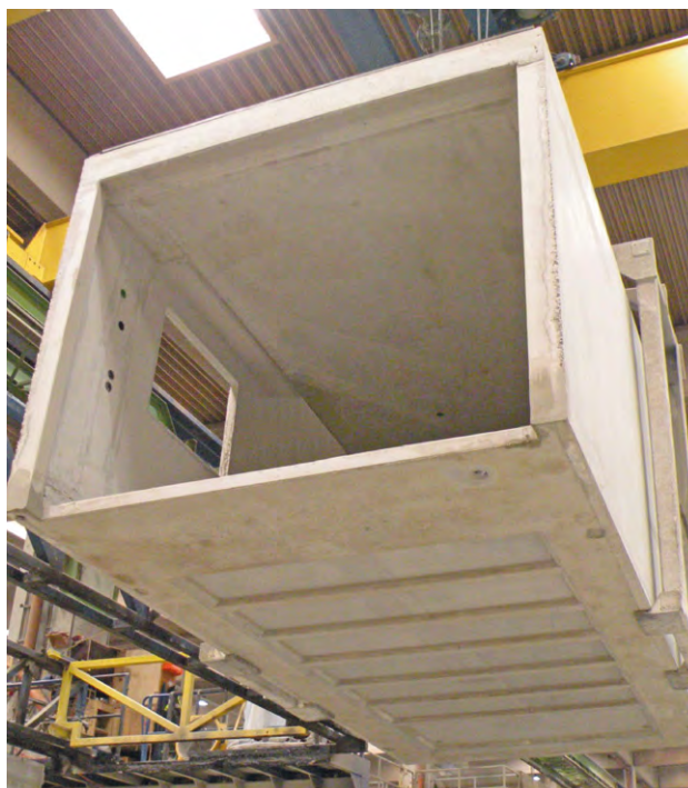
Ansicht der Bodenplatte aus Carbon-/Textilbeton.
